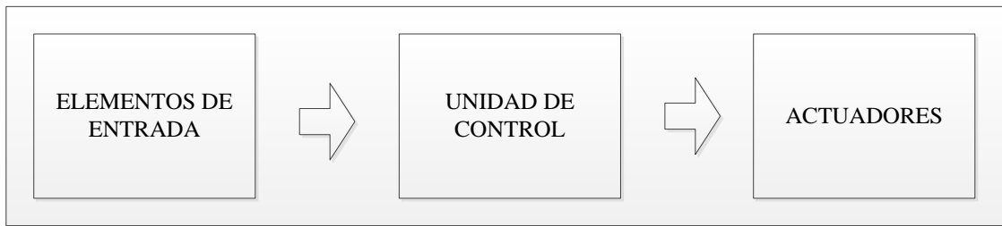
Gráfico 2-2. Estructura de un sistema automatizado
