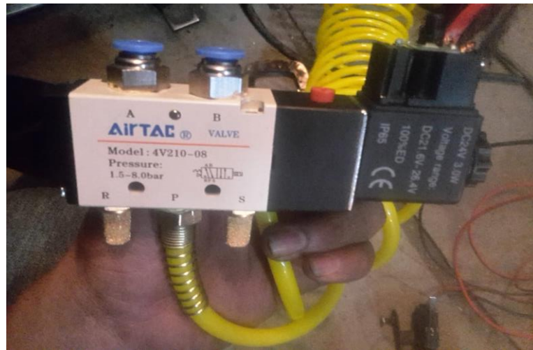
Figura 11-4. Instalación de la electroválvula Realizado por: Henry, Acaro; Marco, Terán, 2019
