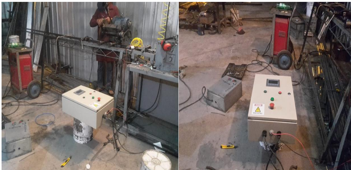
Figura 12-4. Conexión de la caja de control a la estructura Realizado por: Henry, Acaro; Marco, Terán, 2019
