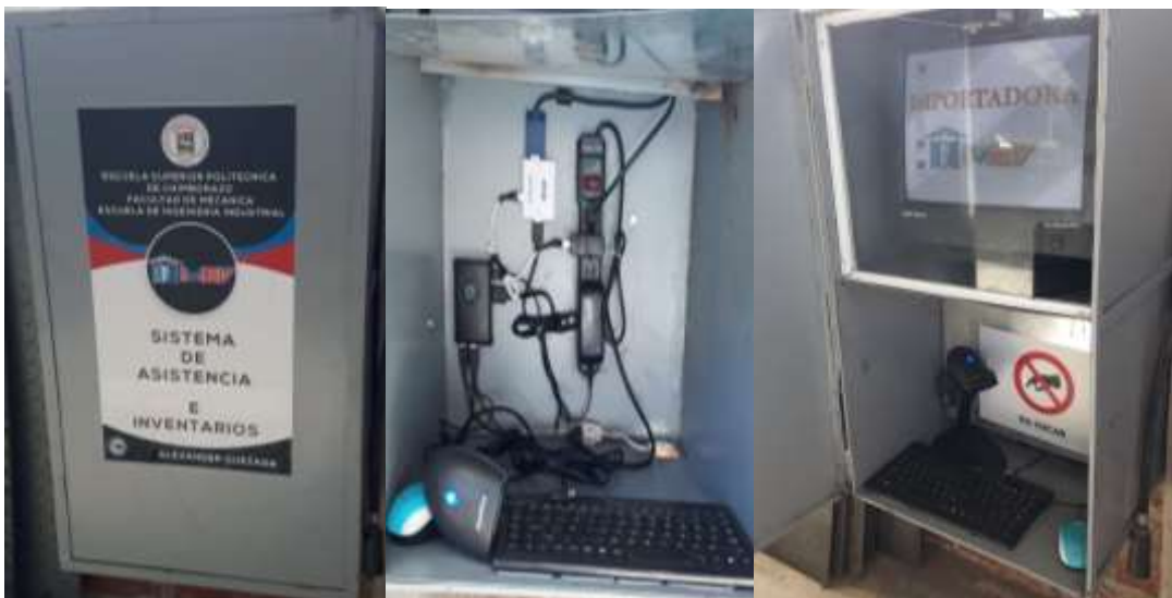
Figura 38-4: Implementación del Sistema automatizado de gestión de inventario y control de acceso a las bodegas de almacenamiento.
