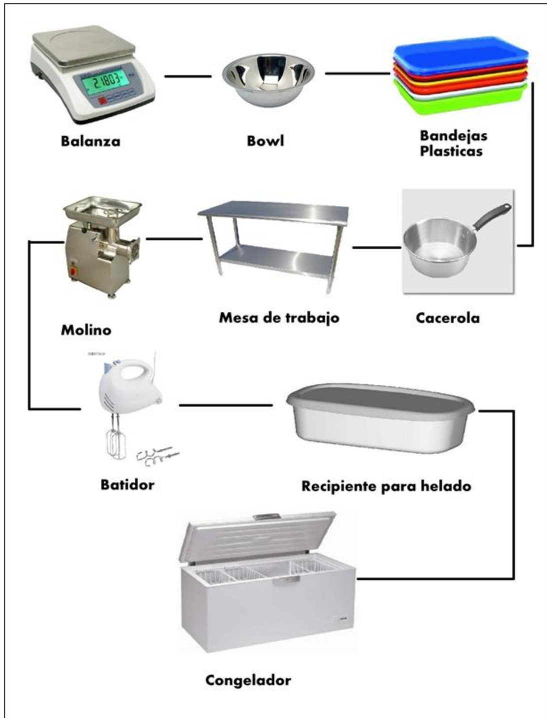
FIGURA 08- Diagrama de equipamiento para la elaboración de Helado.
