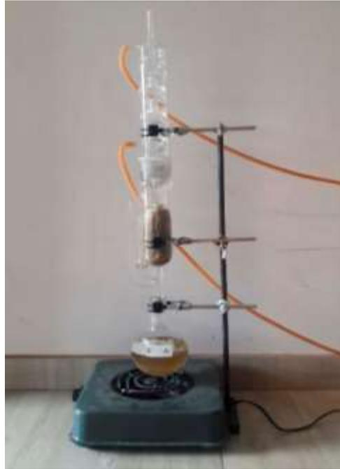
**Fotografía 3:** Extracción de saponinas de los residuos de *Chenopodium quinoa* Willd por el método Soxhlet.
