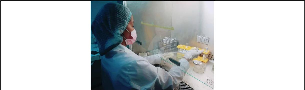
**Fotografía N°10:** Siembra de las muestras del agua de la Laguna en las cajas Petri con PCA, PCA.AL, PCA suplementado con glifosato para el recuento de bacterias.
