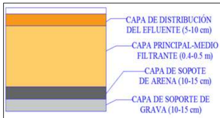
Figura 3-1: Parámetros de un Biofiltro
