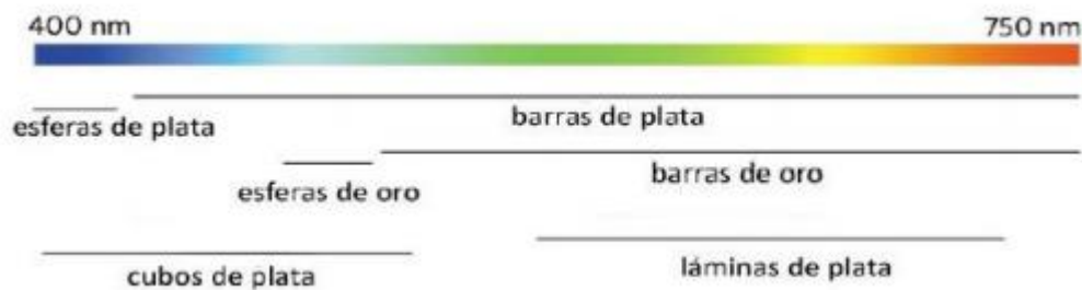
Figura 1-1: Diferentes morfologías de nanopartículas de oro y plata y su localización en el espectro UV-Vis según la resonancia del plasmón superficial.
