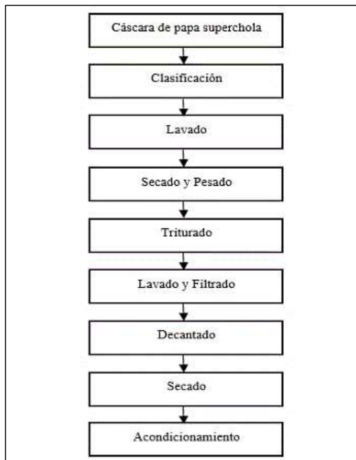
Figura 2-3: Diagrama de flujo para el proceso de extracción.
