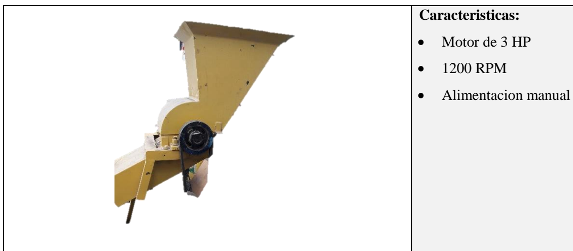
Figura 4-3 Triturador rediseñado.
