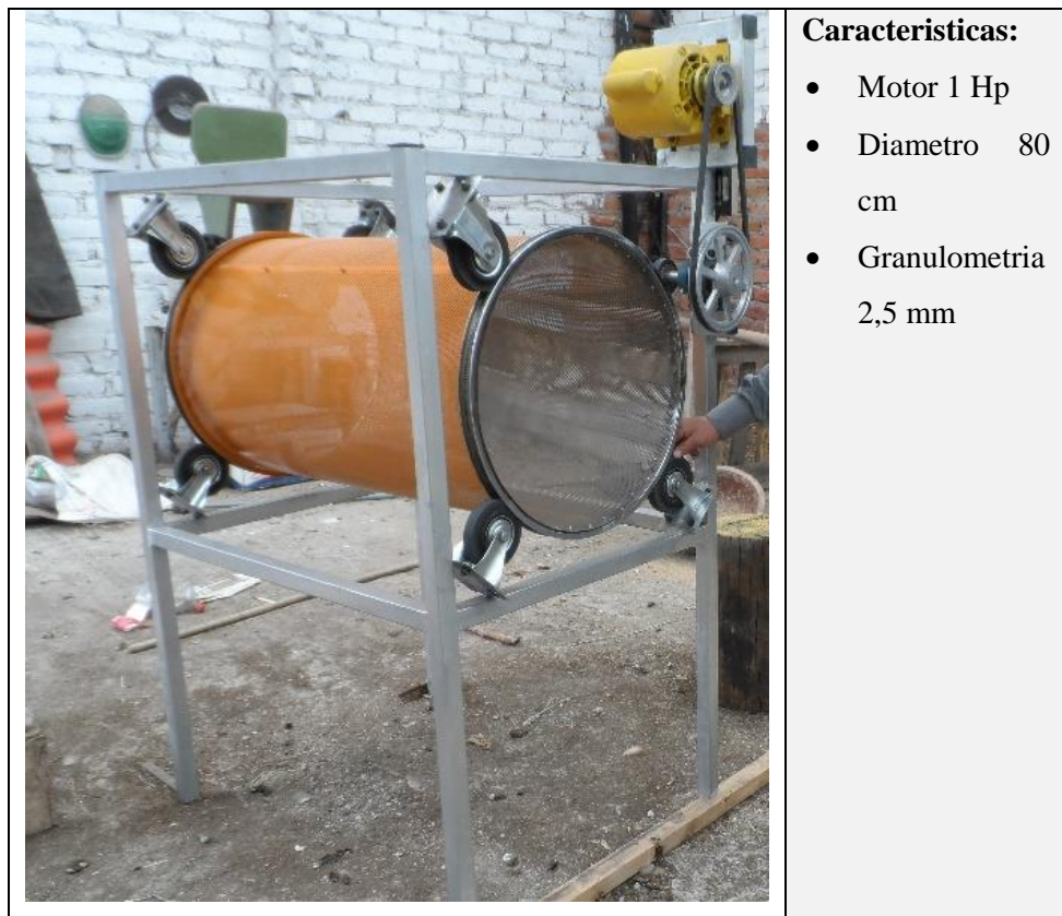
Figura 5-3 Diseño de la zaranda rotatoria.
