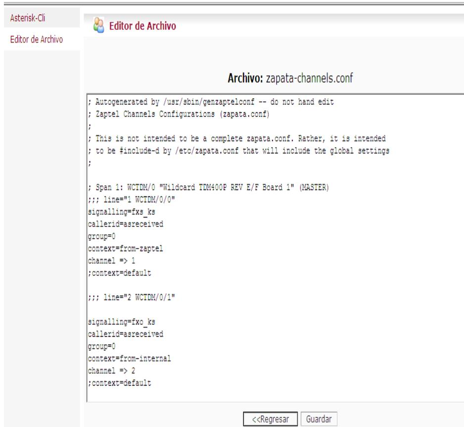
**Figura 4.19 CONFIGURACIÓN ZAPATA-CHANNELS.CONF**
