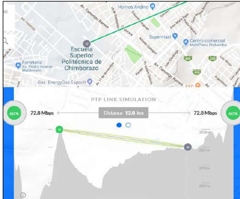
Figura 18-2: Perfil de Radioenlace entre Chingazo y FIE
