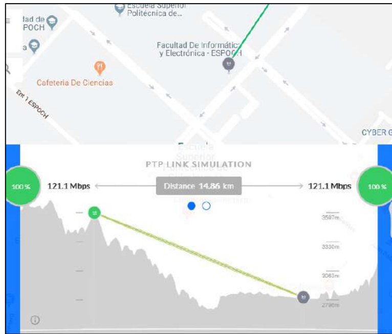
Figura 20-2: Perfil de Radioenlace entre Igualata y FIE Realizado por: Francisco Shagñay, 2018
