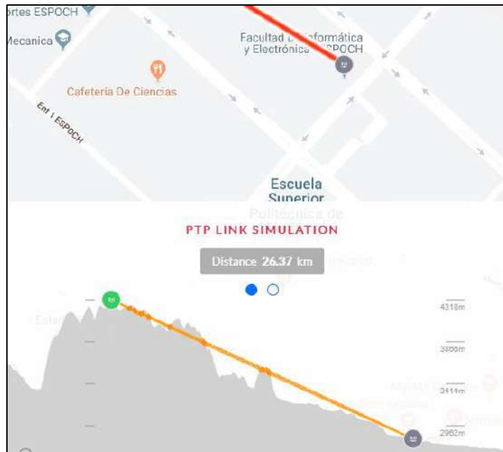
Figura 22-2: Ubicaciones del Transmisor en Chimborazo y Receptor en FIE
