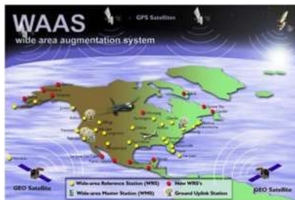
Figura 32-1: Sistema de Aumentación Basado en Satélites (WAAS)
