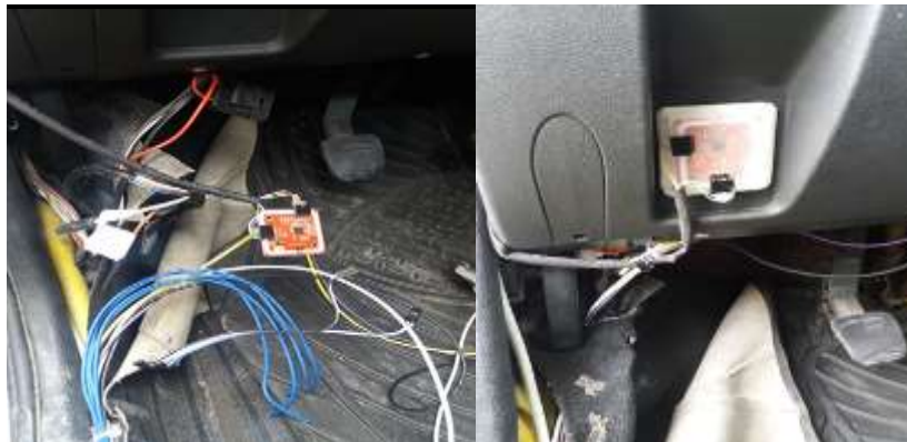
Figura 87-2: Instalación de los Módulos PN532 NFC en el vehículo Realizado por: Tapuy, W. 2018
