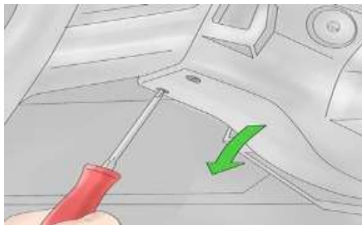
Figura 6-2: Retiro de la cubierta de plástico Fuente: wikihow - https://bit.ly/2BUMo3i
