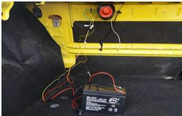
Figura 88-2: Instalación de la Batería y la alarma en la cajuela del vehículo Realizado por: Tapuy, W. 2018
