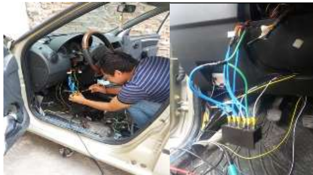
Figura 85-2: Instalación del Relé para el encendido del vehículo
