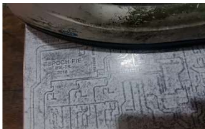
Figura 75-2: Planchado del circuito en Baquelita PCB Realizado por: Tapuy, W. 2018
