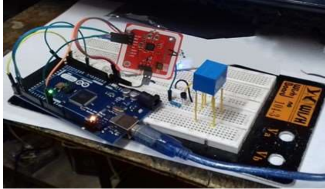
Figura 71-2: Funcionamiento del Relé de 12V – 10A Realizado por: Tapuy, W. 2018
