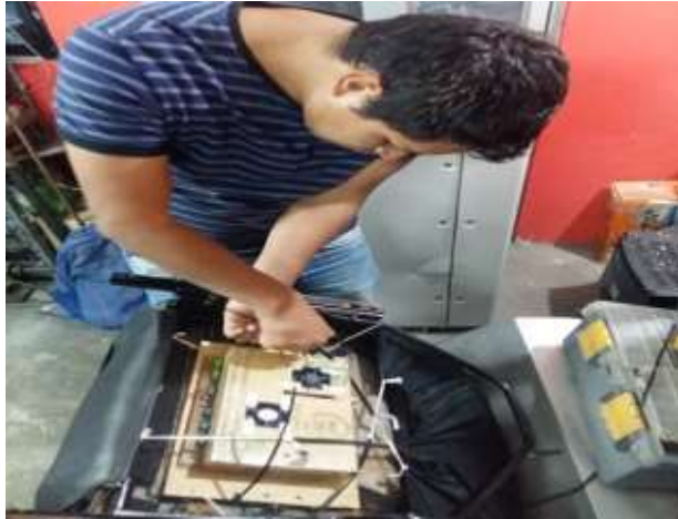
Figura 83-2: Instalación del prototipo bajo el asiento delantero del conductor
