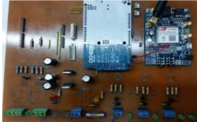
Figura 77-2: Soldadura e inserción de los elementos Realizado por: Tapuy, W. 2018
