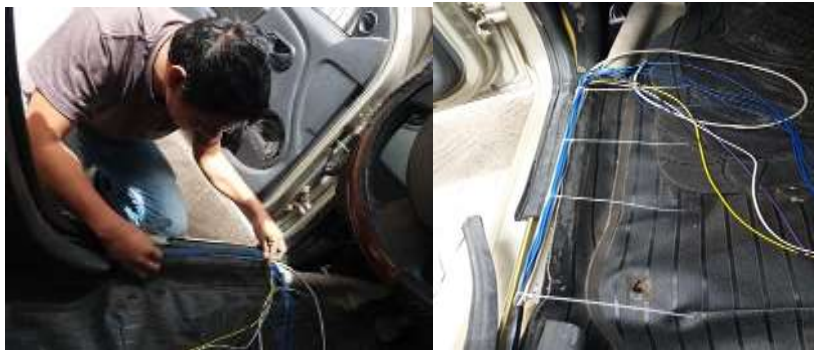
Figura 84-2: Instalación de cables en el vehículo Renault Logan 2009
