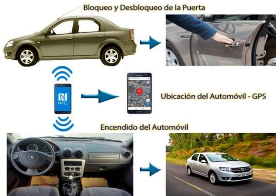
Figura 1-2: Arquitectura general del Prototipo Electrónico Realizado por: Tapuy, W. 2018
