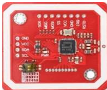
Figura 22-2: Módulo PN532 NFC Fuente: Munguia, F. 2016 - https://n9.cl/OPvJ
