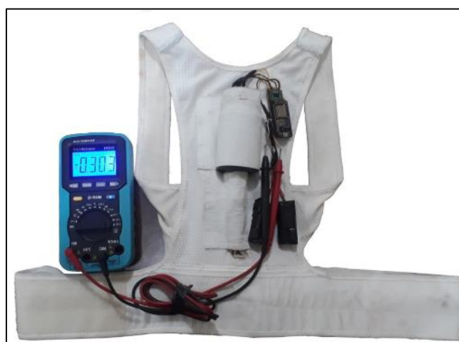
Figura 9-3: Consumo de corriente del Prototipo
