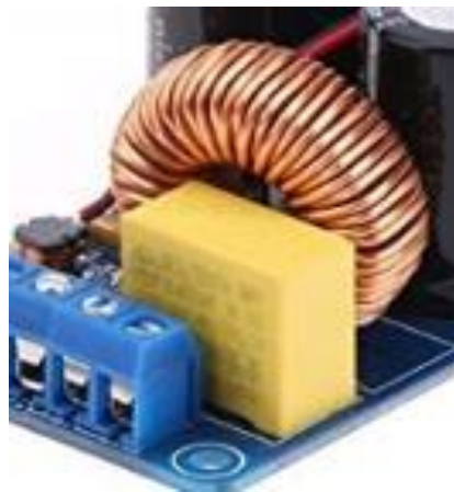
Figura 20-2: Filtro paso bajos
