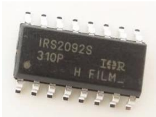
Figura 16-1: Integrado IRS2092, SOIC16N
