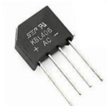
Figura 1-2: Puente de diodos
