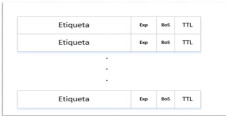
**Figura 2-5:** Pila de Etiquetas
