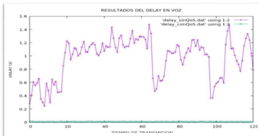
**Figura 4-19:** Resumen del Delay en el tráfico de voz
