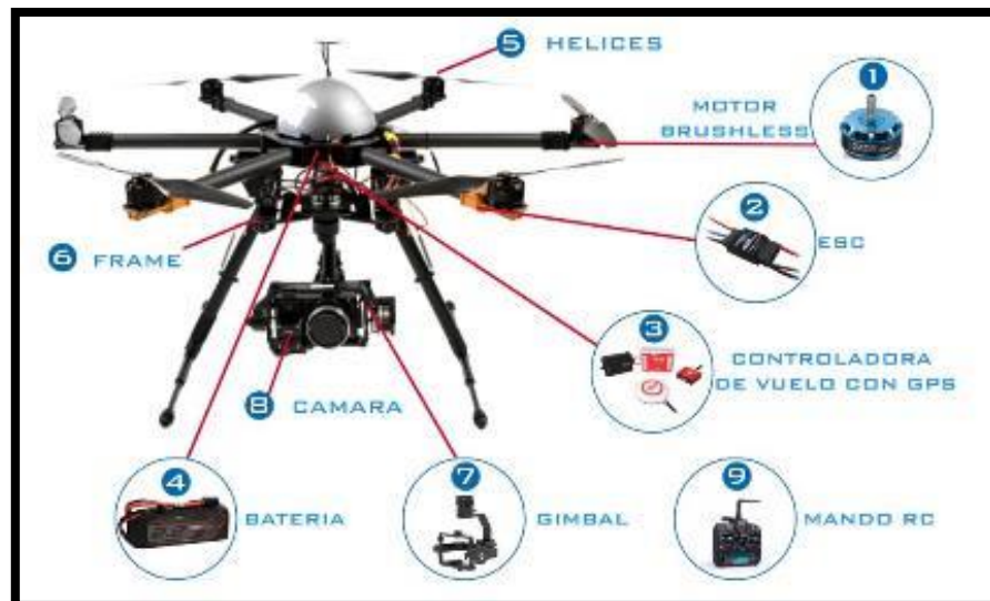
Figura 8-1. Partes de un drone multirrotor.
