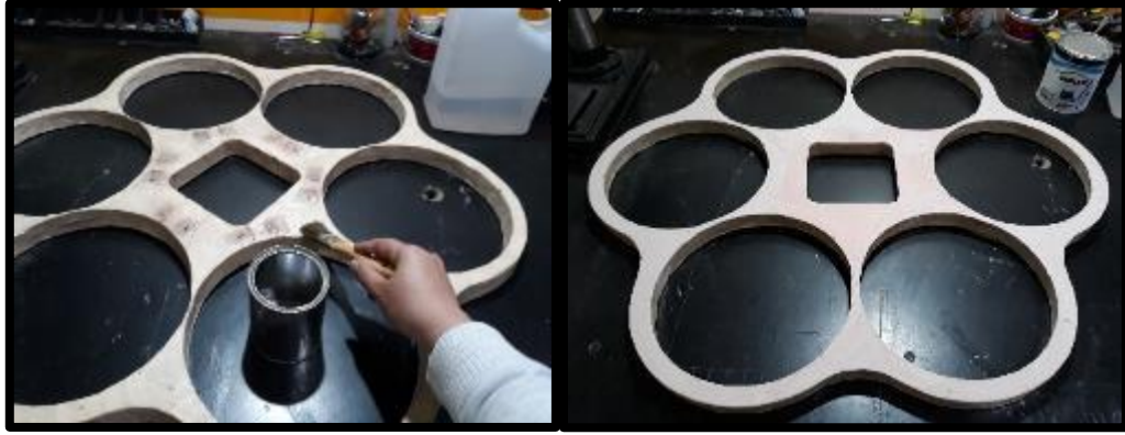
Figura 47-2. Construcción de la protección estructural para las hélices.
