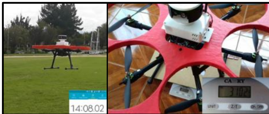
Figura 9-3: Desarrollo de pruebas de autonomía y peso.
