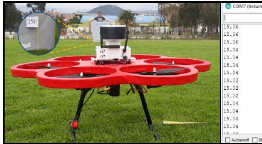
Figura 2-3: Toma de muestras del sensor Lidar lite.
