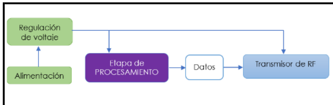
Figura 5-2. Diagrama de bloques de la etapa de transmisión.
