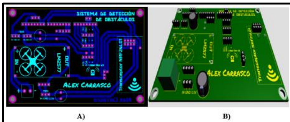
Figura 33-2. A) Placa PCB diseñada en Proteus. B) Vista en 3D de la placa.
