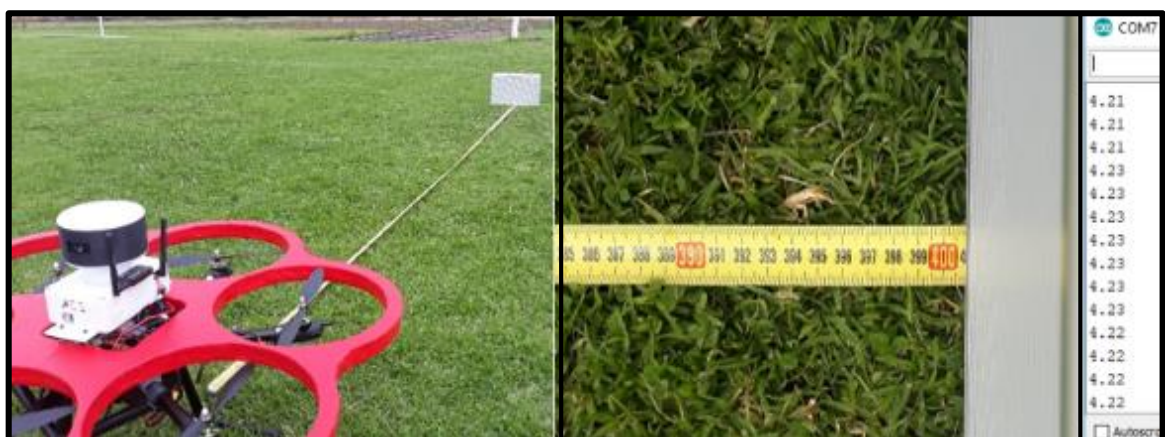
Figura 3-3: Recopilación de datos con los sensores TFmini.
