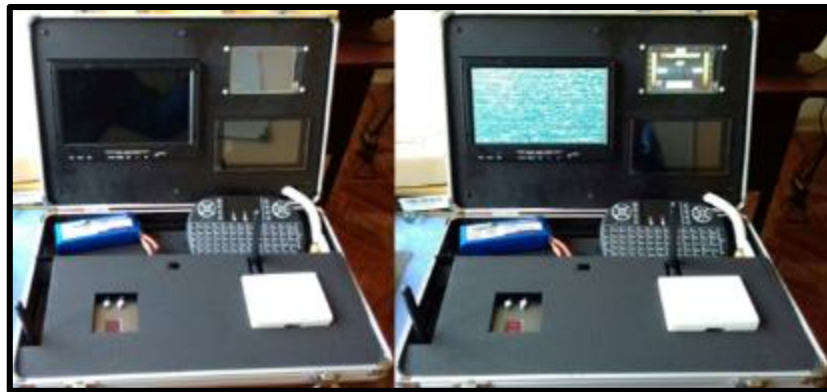
Figura 48-2. Estación de monitoreo en tierra terminada.
