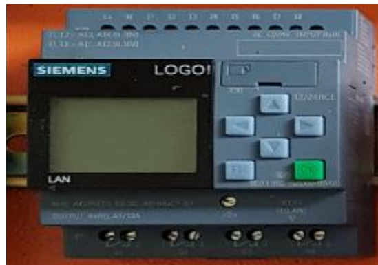
Figura 17-2 Siemens Logo V8. Realizado por: Gavilanes A. 2018
