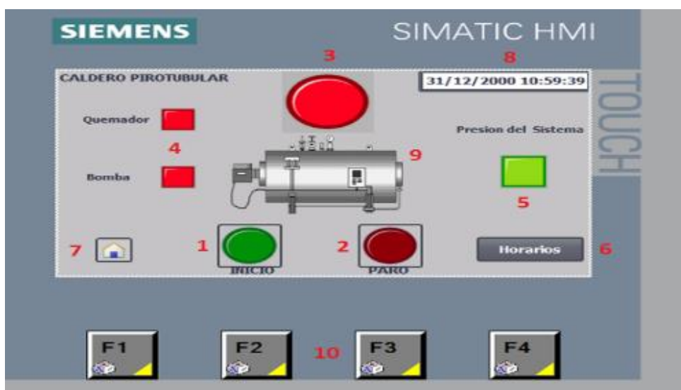
Figura 26-2 HMI pantalla de control del sistema. Realizado por: Gavilanes A. 2018
