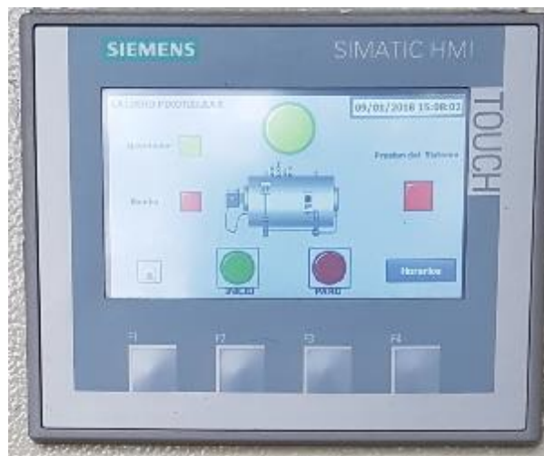
Figura 18-2 Siemens KTP 400. Realizado por: Gavilanes A. 2018
