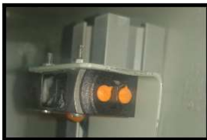
Figura 9-3: Sensor expuesto a pruebas de polvo y temperatura
