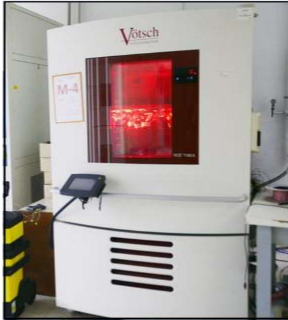
Figura 2-1: Prueba de temperatura en cámara de ensayo
