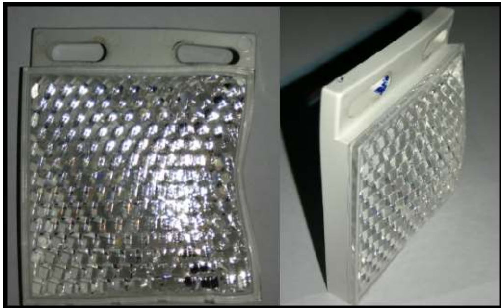
Figura 11-3: Panel nido de abeja expuesto a pruebas de temperatura
