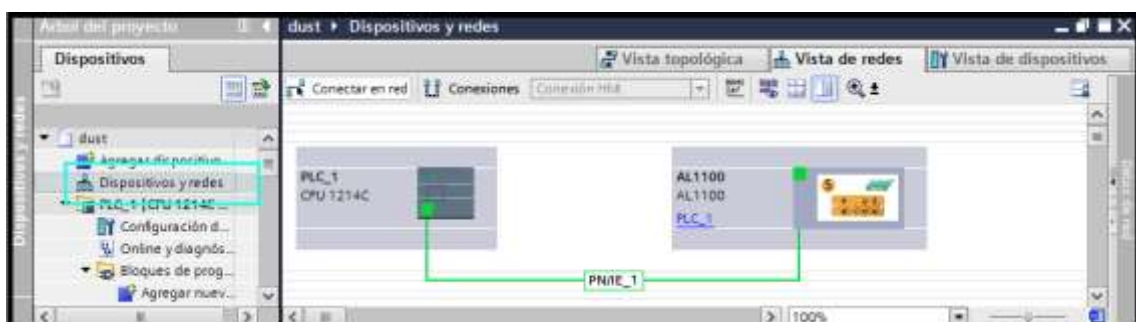
Figura 26-2: Comunicación PROFINET entre PLC y Maestro IO-Link
