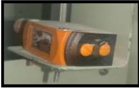
Figura 10-3: Sensor expuesto a pruebas de polvo y humedad
