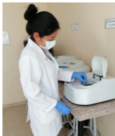
27. Medición de absorbancia en el espectrofotómetro
