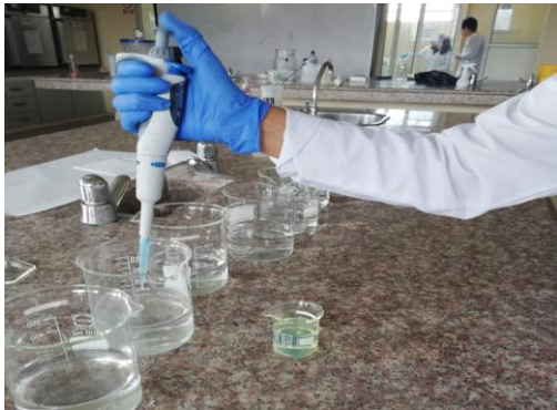
9. Preparación de agua contaminada con diesel
