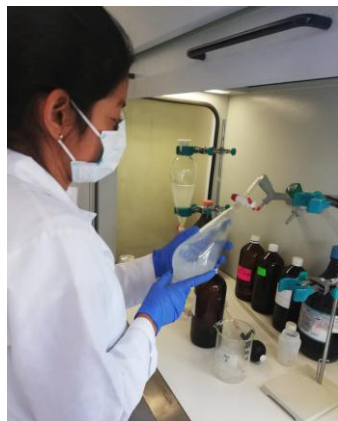
23. Extracción de hidrocarburos con hexano
