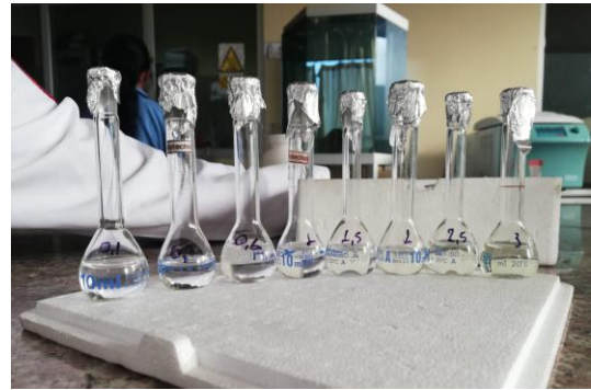
8. Diluciones utilizadas en la curva de calibración
