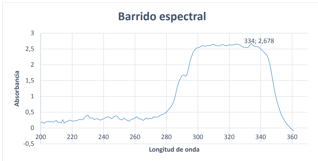
Gráfico. Barrido espectral de la solución para determinar la curva de calibración
