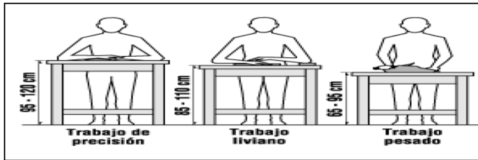
Figura 3-1: Norma Técnica para el diseño de mesas de acero inoxidable para el corte de camote.
