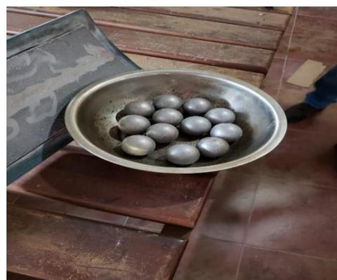
**Fotografía 14:** 12 Bolas para el ensayo.
