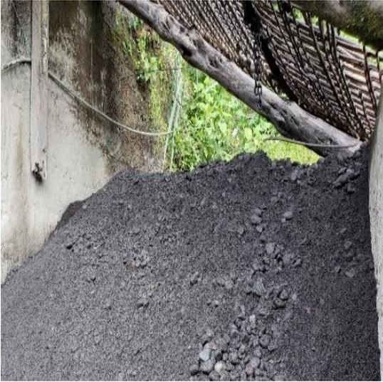
**Fotografía 16:** Clasificación mediante una criba.
