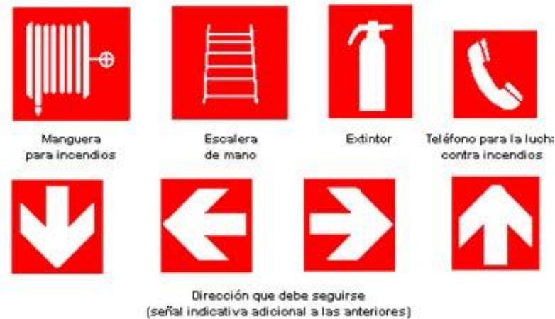
Figura 4-2. Señal de equipos contra incendio.
