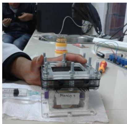
**Fotografía 12-2:** Alimentación con agua residual sintética preparada
