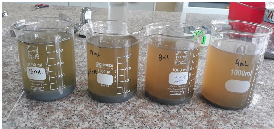
Fotografía: 11-2: Resultados de la prueba de jarras. Realizado por: Emils Mosquera, 2018.
