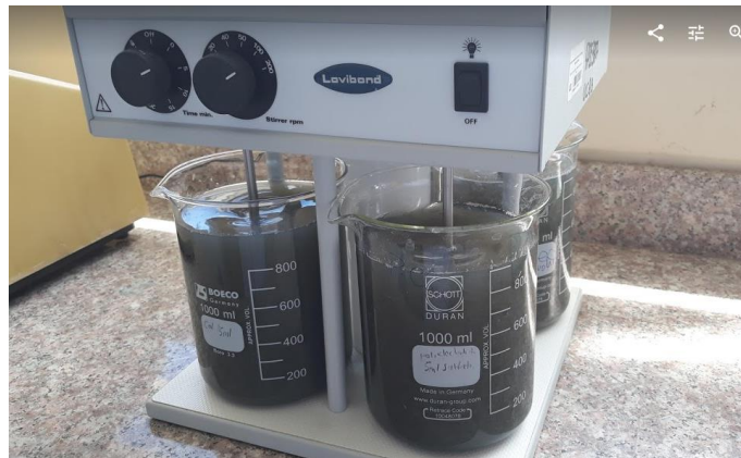
Fotografía: 10-2: Realización de la prueba de jarras. Realizado por: Emils Mosquera, 2018.
