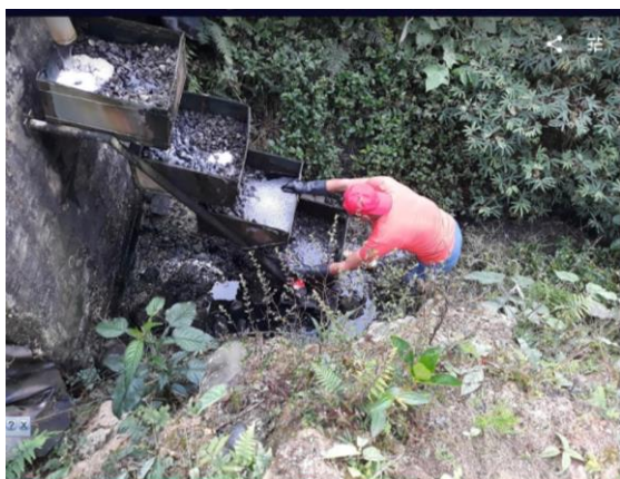
Fotografía: 4-2: Toma de muestras de lixiviado tratado.
