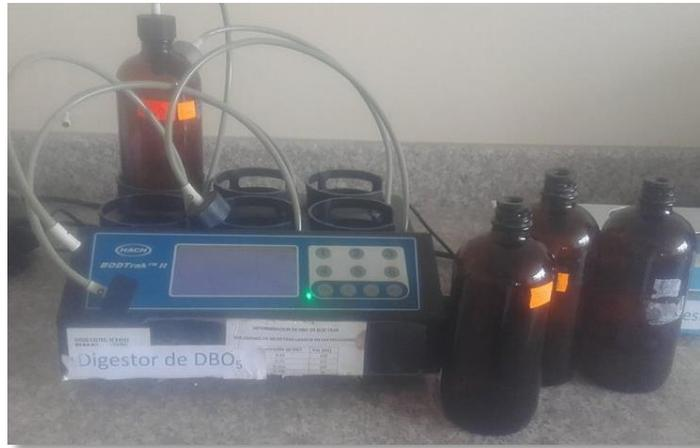
**Fotografía 8-2.** Medición de la DBO5 por gasometría
