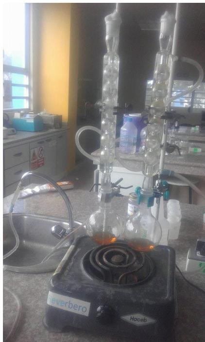
**Fotografías 9-2.** Medición de DQO por volumetría
