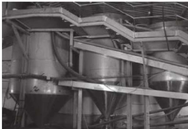
**Figura 6-3:** Sedimentadores cilíndricos de base cónica.
