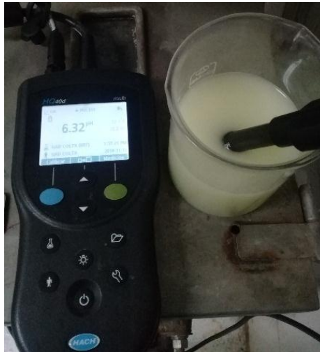
Fotografía 9-3: Medición de pH del suero Realizado por: Marcia Guaila, 2018.
