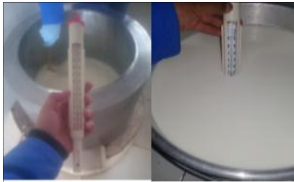
Fotografía 3-3: Medición de temperatura de pasteurización. Realizado por: Marcia Guaila, 2018
