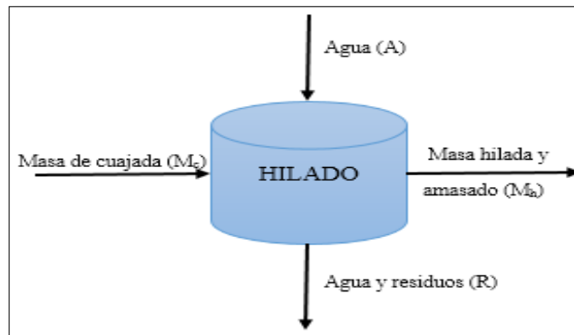
Figura 4-3: Balance de masa en la etapa de hilado
