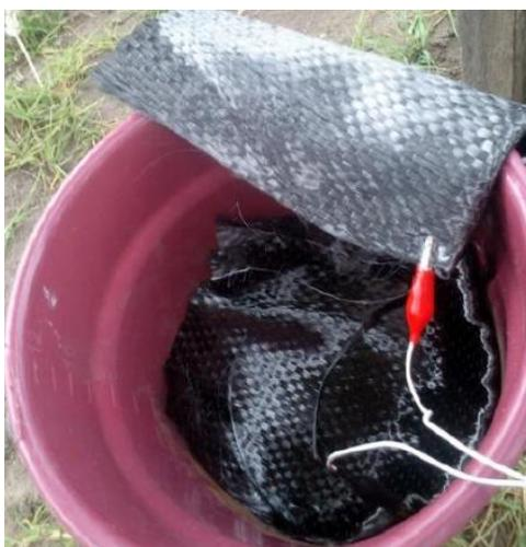
**Figura 2-2.** Electrodo de fibra de carbono en CCM con materia orgánica.
