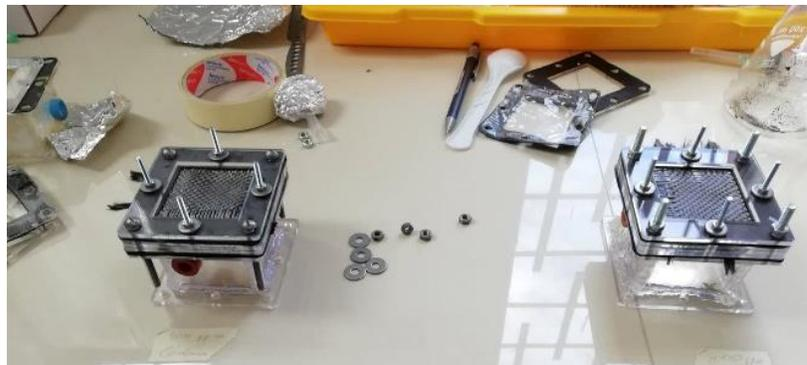
**Fotografía 13-2.** Apreciación de las CCMs con tejido de fibra de carbono como electrodos.
