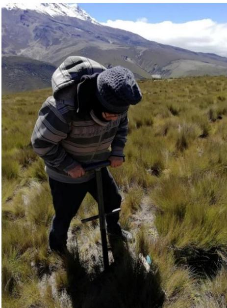
**Fotografía 5-2.** Inserción del barreno en el punto fijado.
