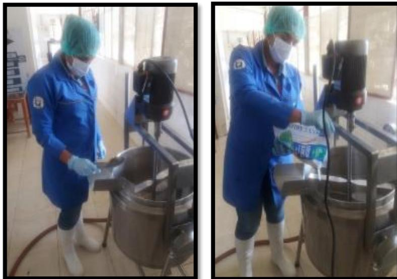
**Fotografía 7-3:** Mezclado y Evaporado del mucílago de cacao
