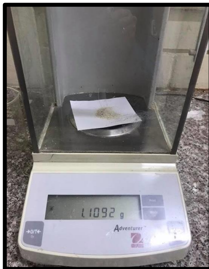
Fotografía 6-3: Pesaje de bisulfito de sodio utilizado para el desencalado. Realizado por: María Abarca, 2018.
