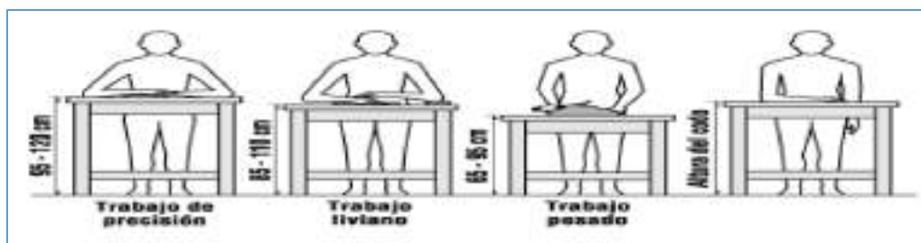
Figura 2-3: Altura estándar de mesa según la correcta ergonomía de acuerdo al trabajo Fuente: Santacruz & Suarez, 2007.
