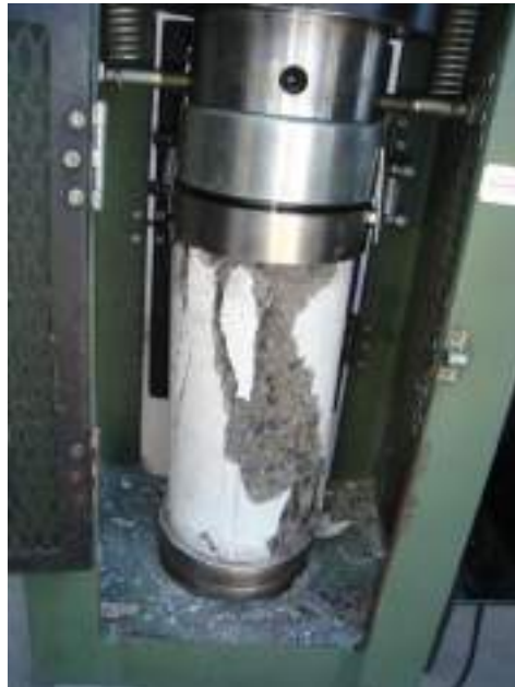
Figura 2-1 Prueba de resistencia de concreto.
