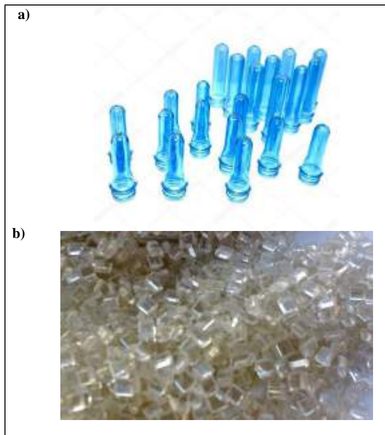
Figura 7-1 a) Matrices para botellas PET, b) Material PET granulado para fabricación de textiles.
