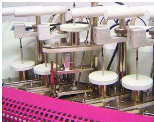
Figura 6-1 Analizador Ceast HDT6/VICAT, para la determinación de la temperatura de flexión bajo carga.
