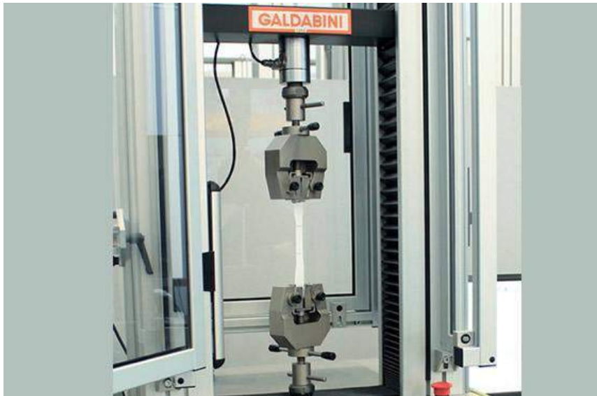
Figura 4-1 Ensayo de tracción de una banda plástica, determinación de elongación a rotura.
