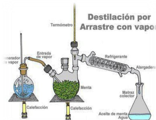
Figura 2-1 Esquema de un equipo de destilación por arrastre con vapor de agua Fuente: (Aguilar- Villalobos, 2012)
