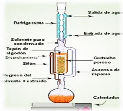
Figura 6-1 Esquema extractor soxhlet
