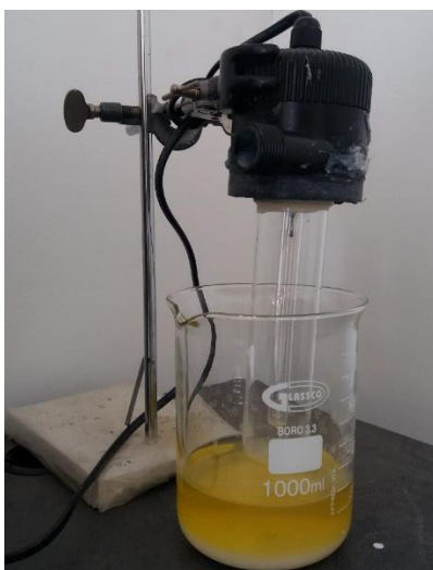
Figura 13-2: Esquema del reactor fotocatalítico empleado para las pruebas con luz UV artificial
