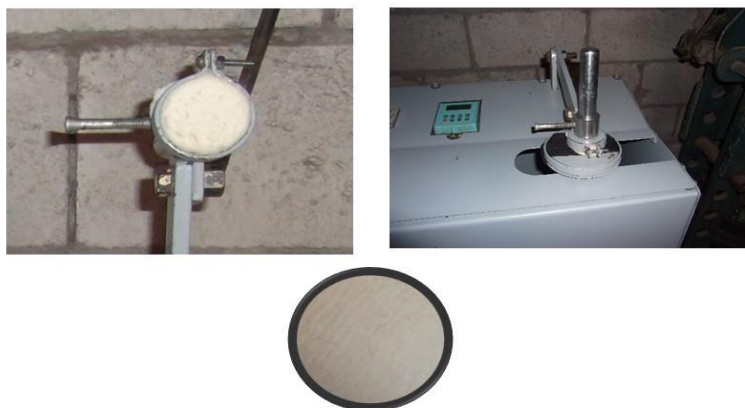
Fotografía 1. Forma de colocar el fieltro en el prototipo mecánico para la medición de la resistencia al frote en seco del cuero.
