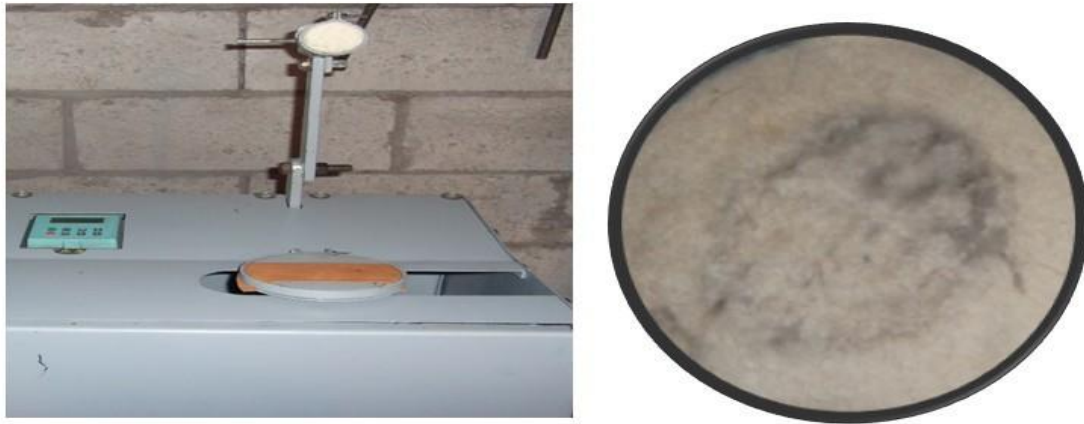
Fotografía 2. Filtro manchado después de la medición de la resistencia al frote en seco realizado en el prototipo mecánico de la Facultad de Ciencias Pecuarias.
