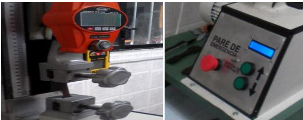
Fotografía 3. Máquina para el test de resistencia a la tensión.
