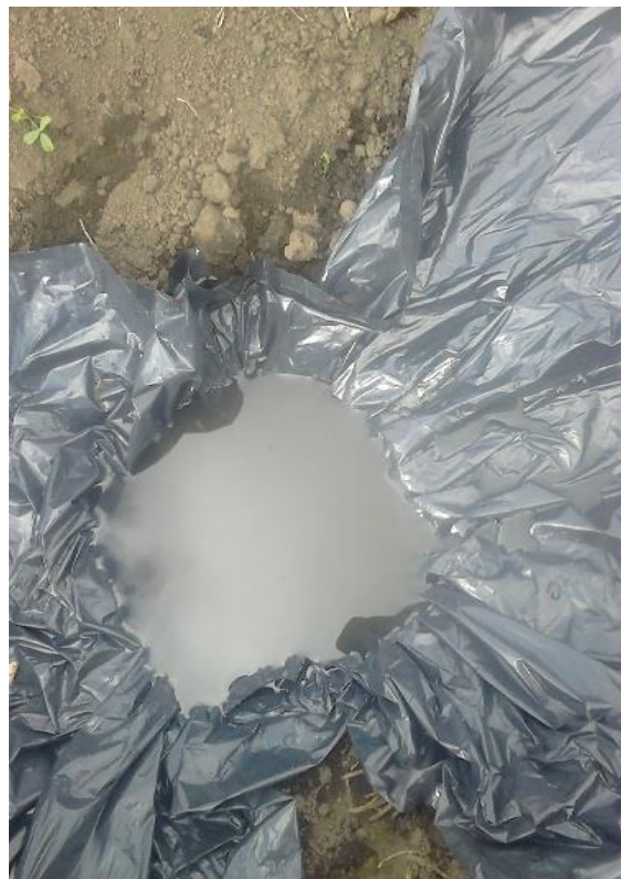
Anexo 18. Llenado de agua en el hoyo para determinar densidad aparente
