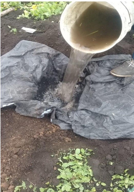
Anexo 18. Llenado de agua en el hoyo para determinar densidad aparente
