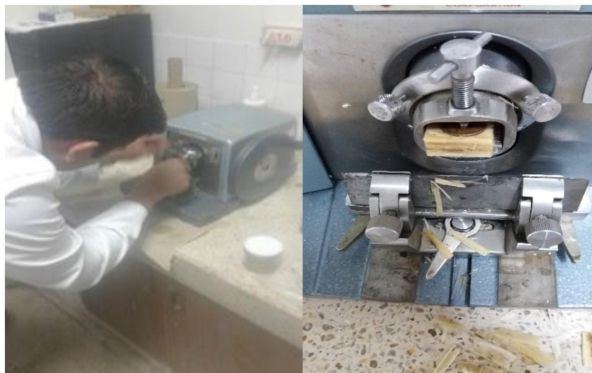
Anexo 21. Corte de las muestras en el micrótopo
