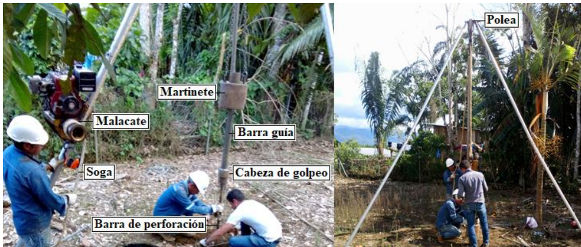
Figura 5: Esquematación general del mecanismo del Ensayo SPT Elaborado por: V. Chica, 2018.
