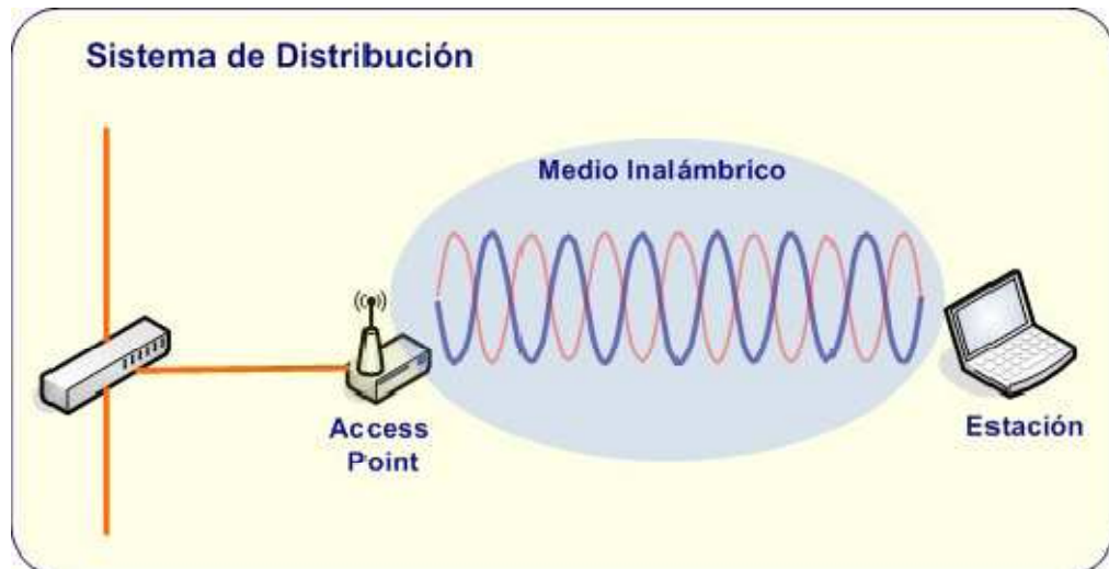
Figura II.1. Componentes de la infraestructura inalámbrica
