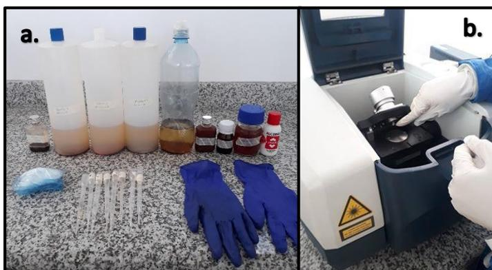
**Figura 4-3:** a. Materiales utilizados en la espectroscopia IR. b. Muestra colocada en espectrofotómetro IR.
