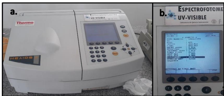
**Figura 5-3:** a. Muestra colocada en el espectrofotómetro. b. Condiciones en las que se realiza el barrido a las NPMs.
