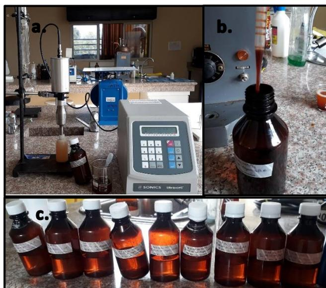
**Figura 11-3:** a. Sonicación de las muestras. b. Preparación de las concentraciones. c. Muestras con tres concentraciones, para un tiempo de sonicación de 10 min.
