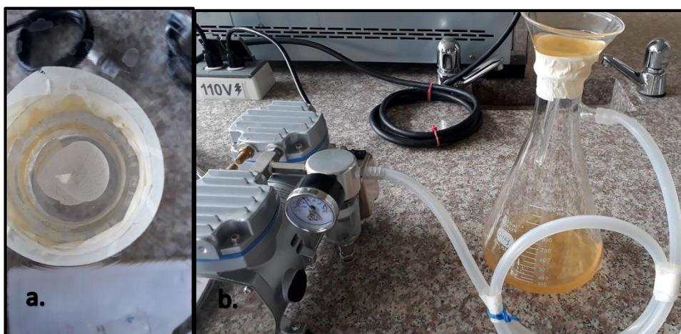
**Figura 8-3:** a. Colocación de la membrana de microfibras de vidrio. b. Sistema de Filtración.
