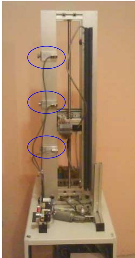
**Figura N° V.59** Sensores magnéticos de posicionamiento.
