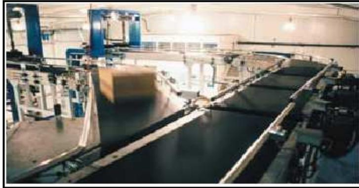
**Figura N° IV.35** Sistema de Transportadores de bandas
