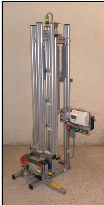
**Figura N° V.73** Módulo elevador de paletizado
