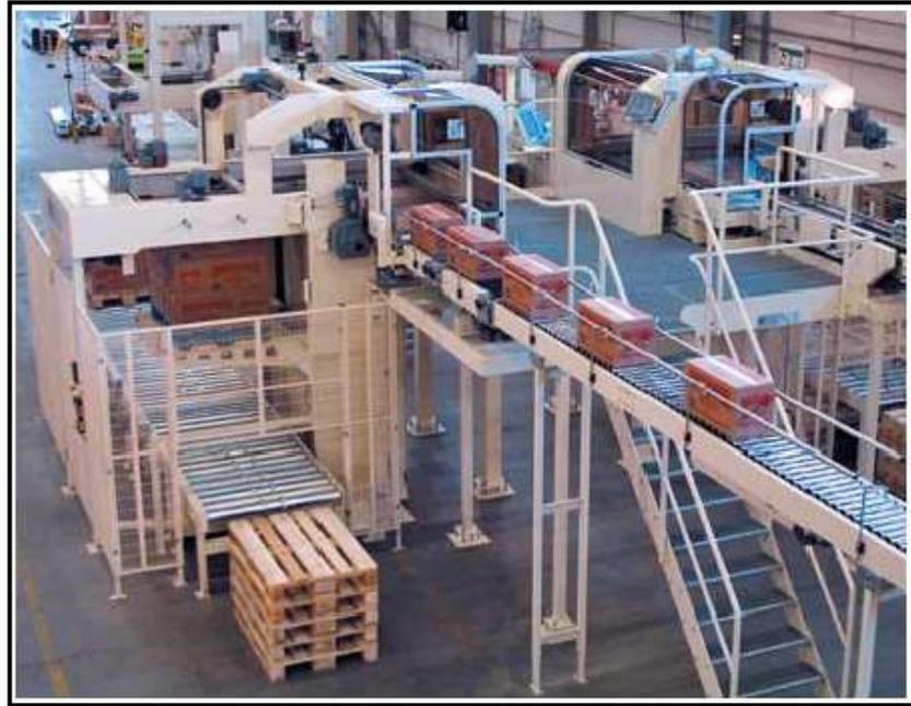
**Figura N° IV.25** Sistema de paletizado
