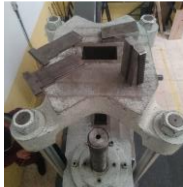
Figura 40-3: Prueba de mordazas en vacío.
