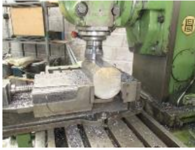
Figura 28-3: Fresado de eje de Acero
