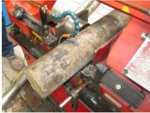
Figura 26-3: Corte de eje de Acero 5115
