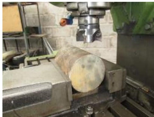
Figura 27-3: Montaje en la fresadora
