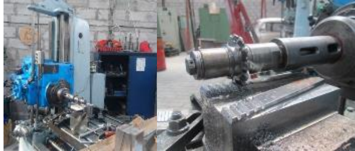
Figura 31-3: Mandrinadora (izquierda), Fresa para generar dientes (derecha)
