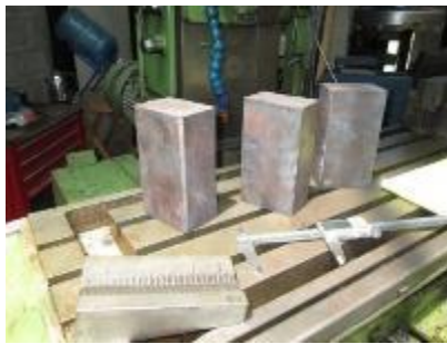
Figura 29-3: Prismas después del fresado
