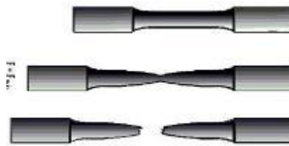
Figura 3-2: Probeta para ensayos a tracción
