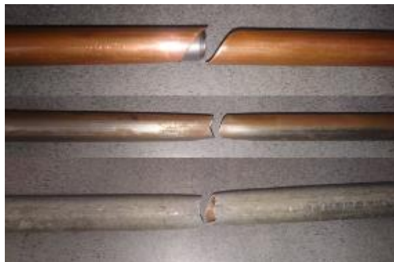
Figura 44-3: Probetas fracturadas después del ensayo
