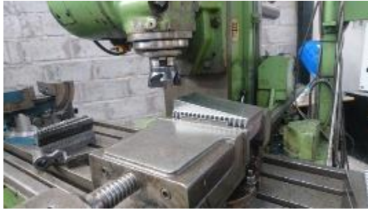
Figura 33-3: Fresado de la geometría piramidal para cuña
