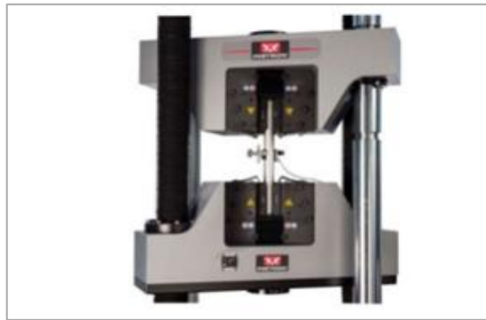
Figura 4-2: Mordazas para tubos de acero de sección circular.
