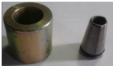
Figura 5-3: Mordaza cilíndrica con bastidor
