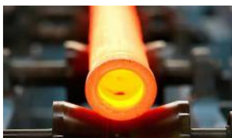
Figura 1-2: Fabricación de tubos sin costura
