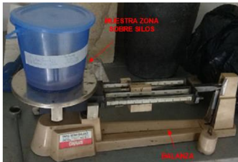
Figura 3 – 1: Medición de la cantidad de polvo en la zona descarga sobre silos.
