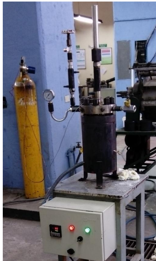
Pirólisis en el reactor batch.
