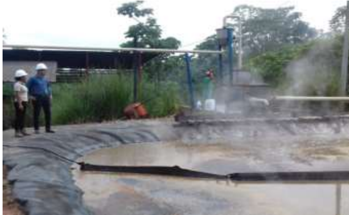
Fotografía 1-2. Medición del caudal de ingreso al sistema de biorremediación.
