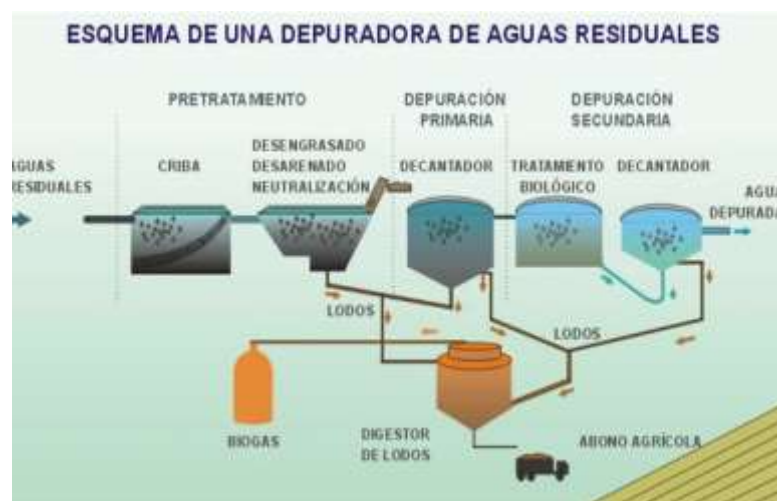
Figura 1-1. Depuradora de aguas residuales.
