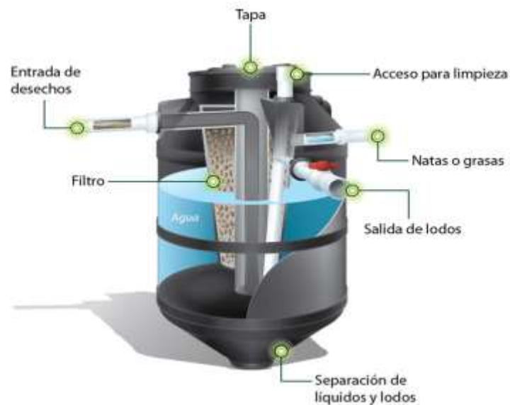
Figura 2-1. Biodigestor de tipo discontinuo.
