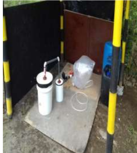
Fotografía 8-2. Obtención del biogás a escala piloto
