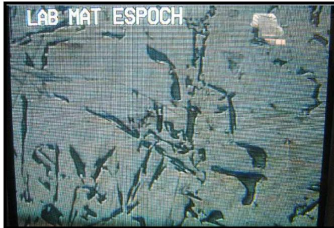
Figura 71: Fotografía de los Micro-constituyentes de la probeta analizada.
