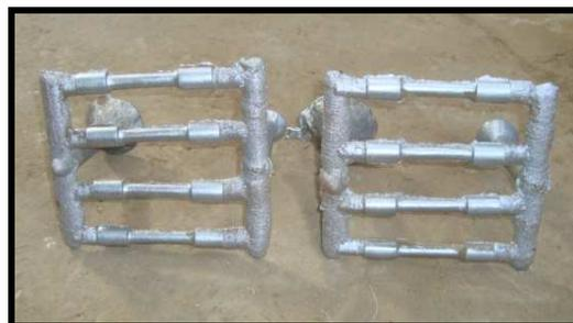
Figura 67: Probetas de aluminio aún con bebederos.
