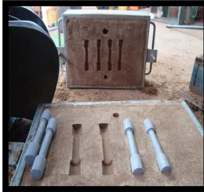
Figura 65: Moldeo de las probetas
