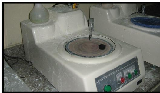
Figura 69:        Probeta en la máquina pulidora.
