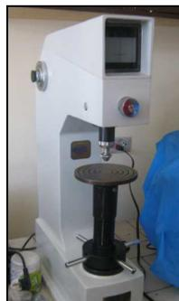
Figura 74: Durómetro.
