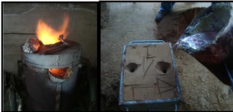
Figura 66: Fundición y vertido de la colada.
