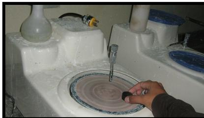
Figura 73: Probeta en la máquina pulidora.
