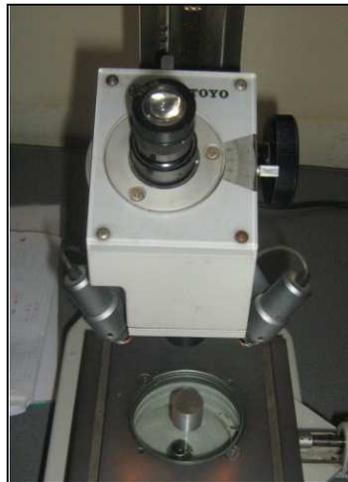
Figura 76: Observación y Medida de la huella marcada en la probeta
