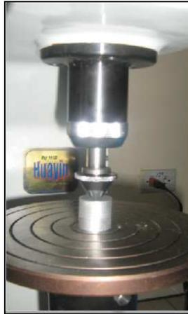
Figura 75: Probeta sometida a carga en el durómetro.
