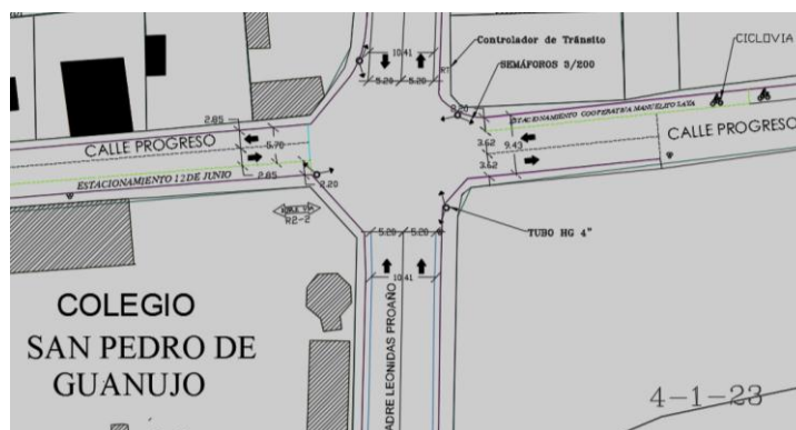
Ilustración 6: Diseño geométrico de la Intersección N° 1
