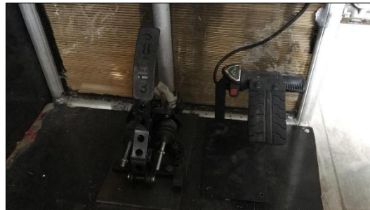
Figura 15-4: Mando analógico de aceleración
