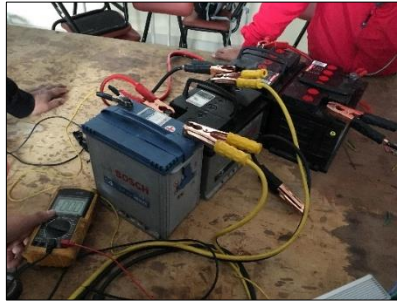
Figura 3-4: Conexión en serie de baterías convencionales de vehículo
