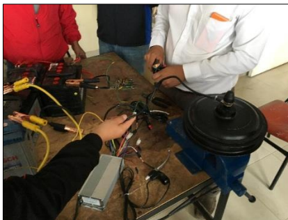
Figura 4-4: Conexión del banco de baterías, controlador y motor Brushless
