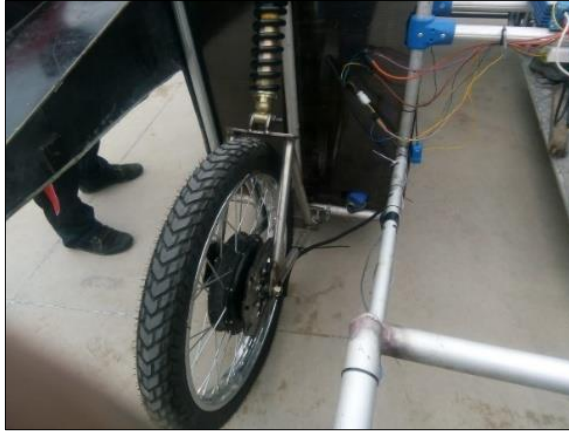
Figura 13-4: Montaje de los motores Brushless al prototipo solar
