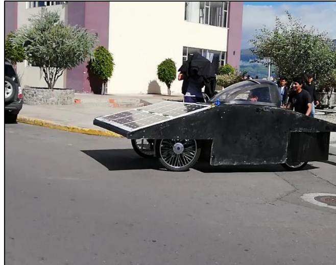
Figura 17-5: Prototipo solar en prueba de ruta (curvas)
