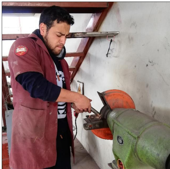
Figura 24-4: Acabado superficial tubos y platinas
