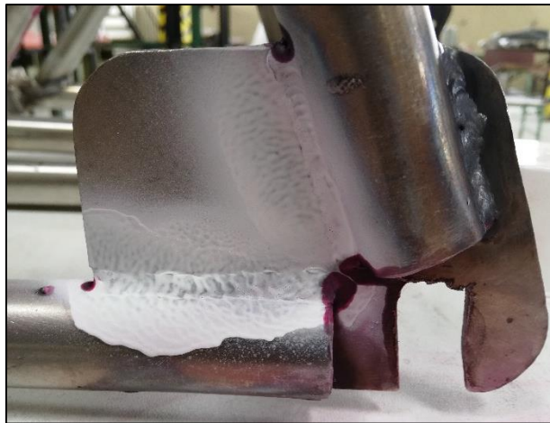
Figura 14-5: Líquido revelador en las uniones del marco de la suspensión posterior
