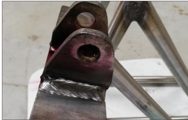
Figura 6-5: Aplicación de líquido limpiador
