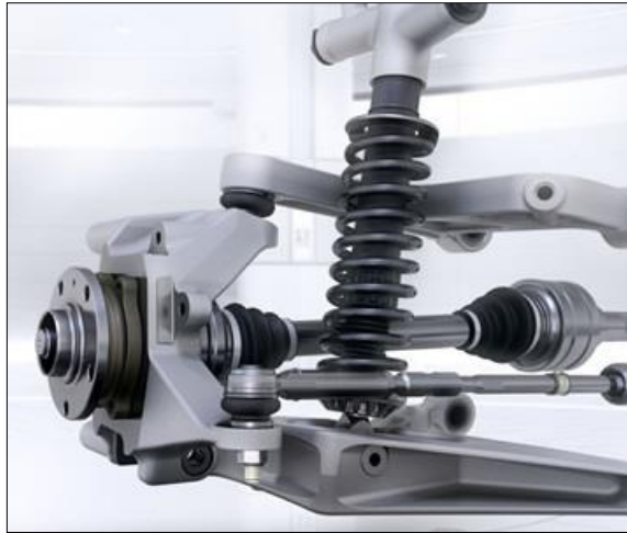
Figura 17-2 Suspensión de paralelogramo.
