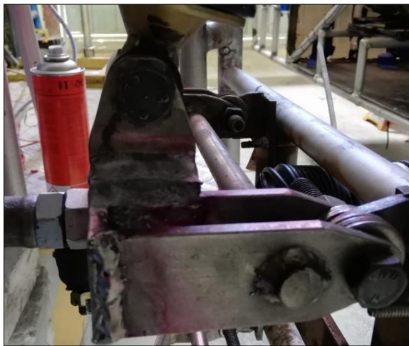
Figura 11-5: Líquido revelador en mesa superior suspensión delantera
