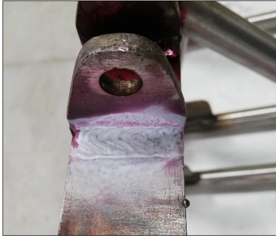
Figura 13-5: Líquido revelador en anclaje amortiguador marco de la suspensión posterior
