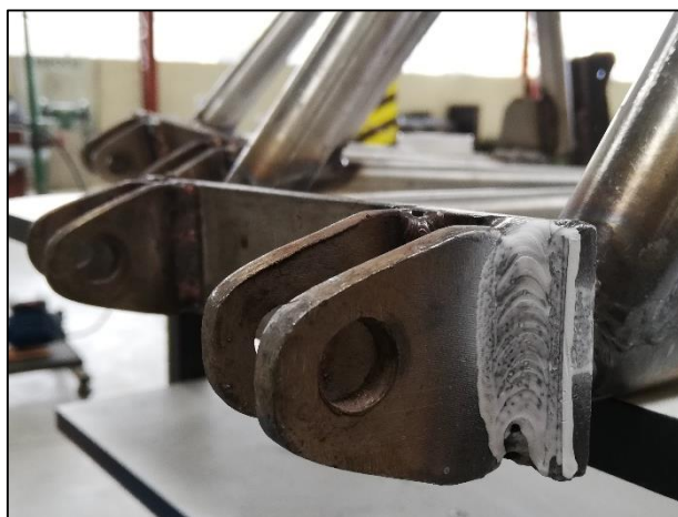
Figura 15-5: Líquido revelador anclajes al chasis marco de la suspensión posterior
