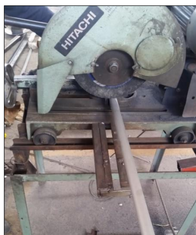
Figura 22-4: Corte de tubos
