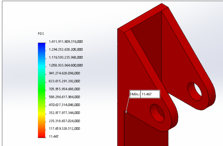
Figura 22-3: Análisis Estático Anclaje amortiguador delantero.
