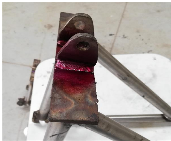
Figura 9-5: Aplicación de líquido penetrante anclajes amortiguador marco de la suspensión posterior
