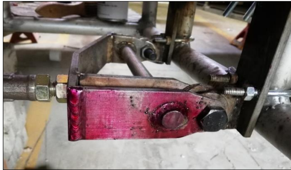
Figura 8-5: Líquido penetrante en la mesa inferior de suspensión.
