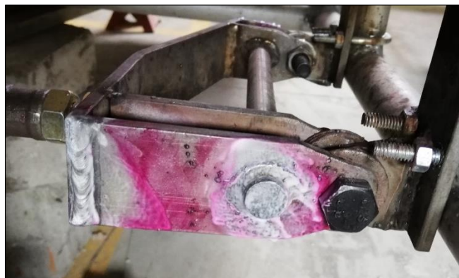
Figura 12-5: Líquido revelador en mesa inferior suspensión delantera
