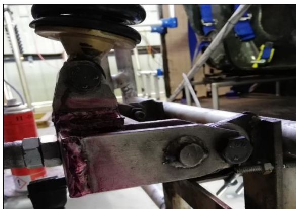
Figura 7-5: Líquido penetrante en la mesa superior de suspensión
