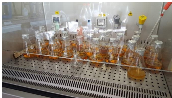
Figura 2-2: Pruebas de degradación de Cr VI en agua sintética
