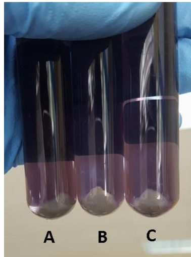
Figura 4-3: Sedimento en las muestras centrifugadas
